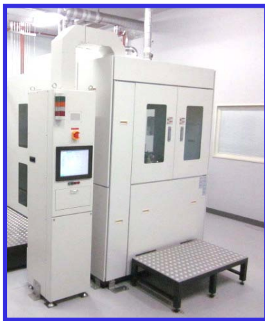
【図3】 新型・枚葉式 SiC 単結晶膜製造装置の外観写真と模式図
