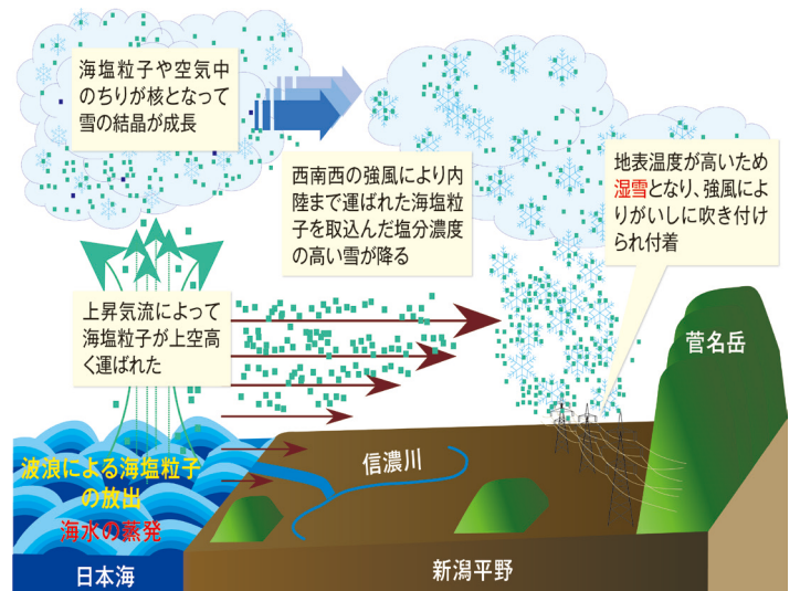
推定される塩雪害の発生メカニズム [第1章参考文献1)に基づき作成]
