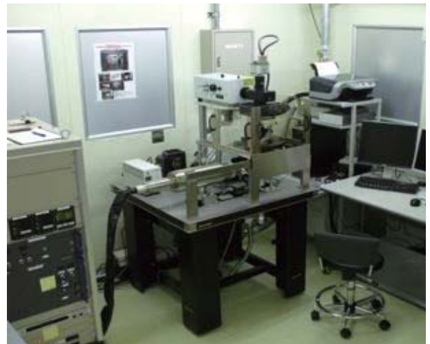
図3-5 マイクロビームX線照射システム フレネルゾーンプレートによる集光光学系を使用
