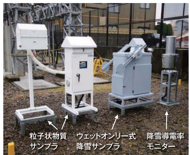
(b) 大気中・降雪中塩分、降雪導電率計測システム
