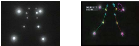
発光状態のターゲットの撮影例(左) これを画像トレースし、電線変位を定量化した例(右)
