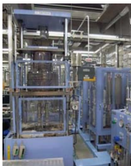
7つのユニットから構成されるSCCの設備群(写真は定荷重試験装置1(PWR))
