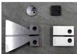
き裂進展速度を求めするための試験片 ピン孔に荷重をかけると、切欠き部で 一方方向にき裂が進む。
