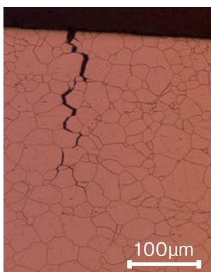
図3-1 金属組織に沿って進むステンレス鋼のSCC
