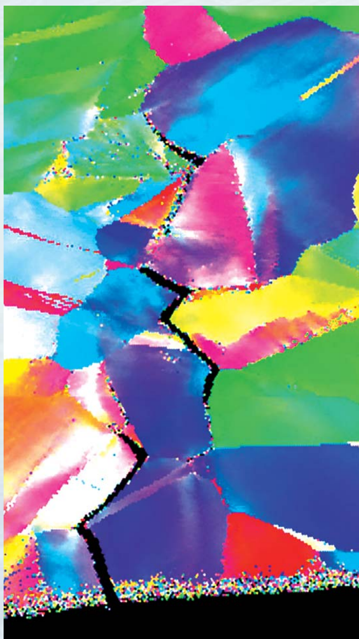
実験によって再現したSCCの断面
