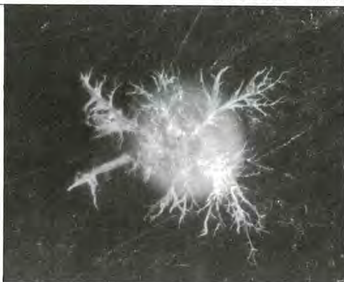
発生した電気トリー(写真)
