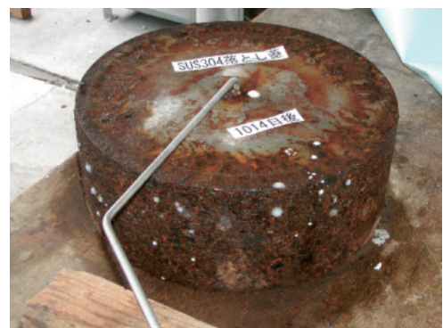
写真5-2-1 密封性能を喪失したキャニスタ1/5縮尺モデル試験体 (304 落し蓋溶接) の例 (白い泡が発生している部分が漏洩位置を示す。)
