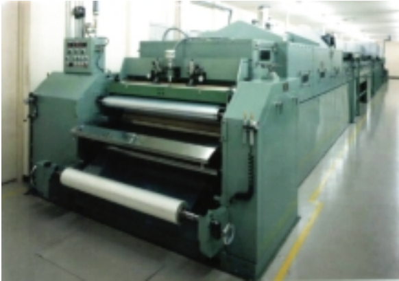
図5-2-1 連続テープ成形設備
