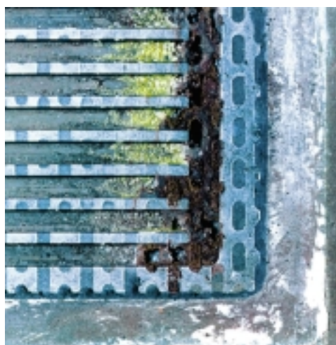
図4-2-9 SO 2 によるカソード流路部 (SUS316L) の腐食
