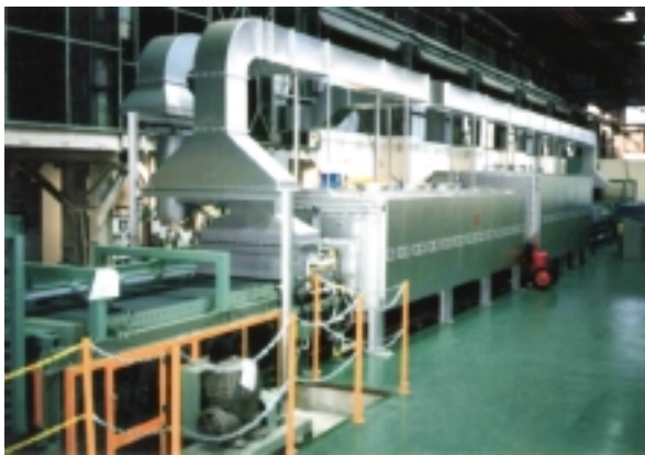
図5-2-2 電極焼成用の連続焼成炉
