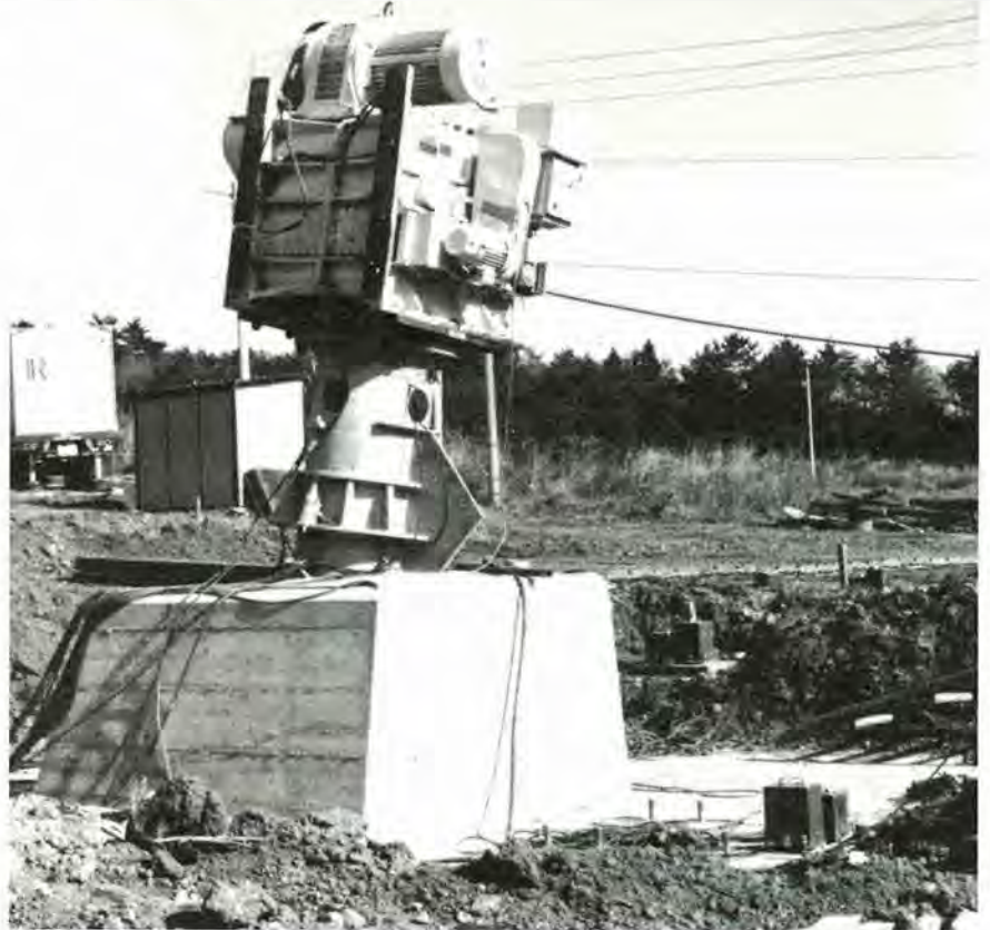
図2-4-4 基礎に据付けた起振機
