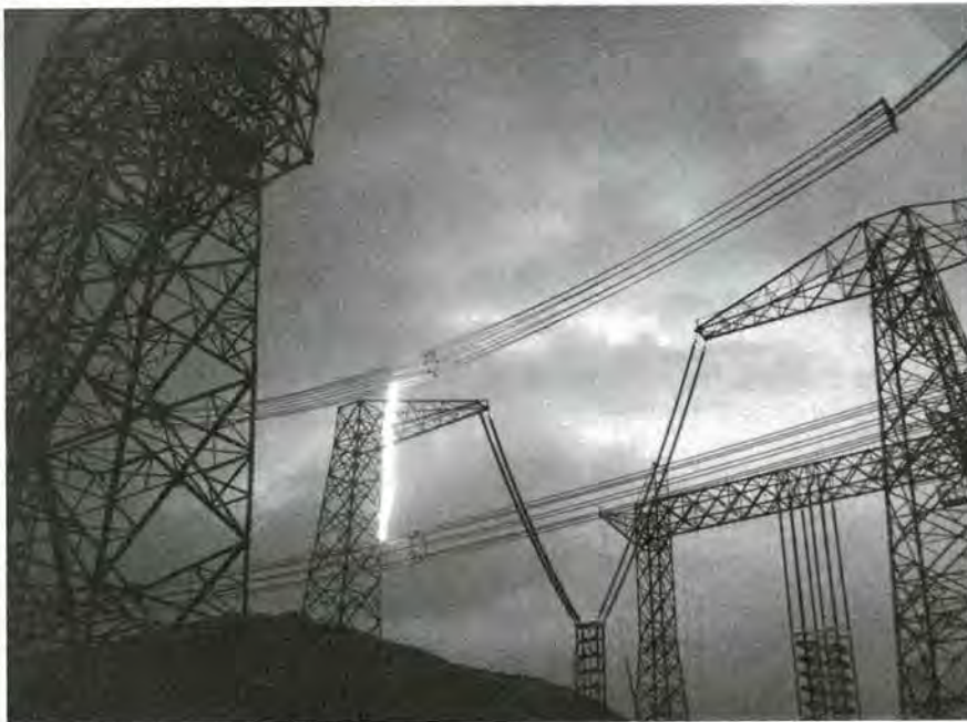
図2-2-4 8 導体—8 導体の相間フラッシュオーバー試験
