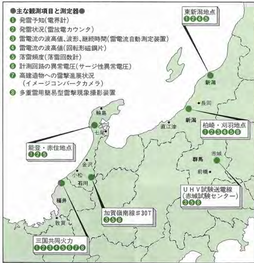
図2-2-6 雷性状の実測対象選定地点と測定器の配置
