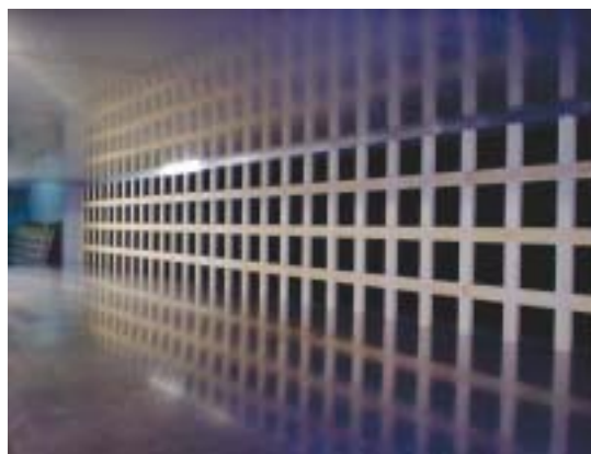
写真4-3-1 風洞吹き出し口（乱流格子設置状況）
