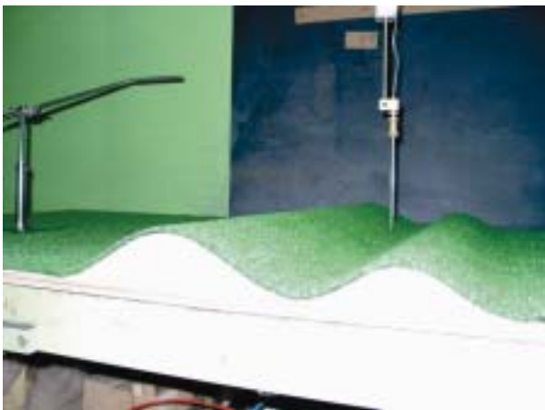
写真4-2-2 2次元2山地形模型実験状況
