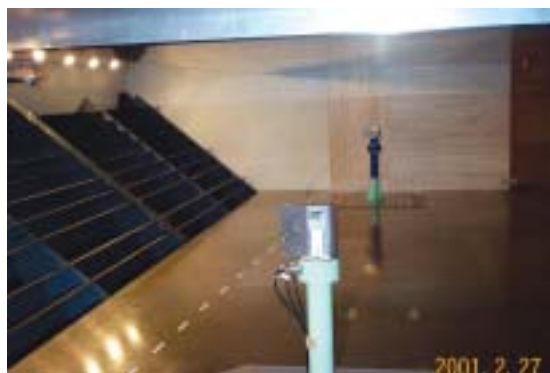
写真4-3-2 架渉線風応答実験の様子（耐長型）
