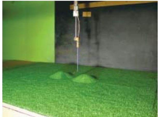
写真4-2-3 3次元2山地形模型実験状況
