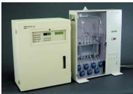
図 1 水銀化学形態別連続分析装置の外観
