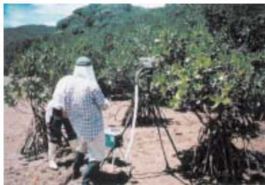
写真4-5-2 マングローブ生態系における温室効果ガス収支測定の様子
