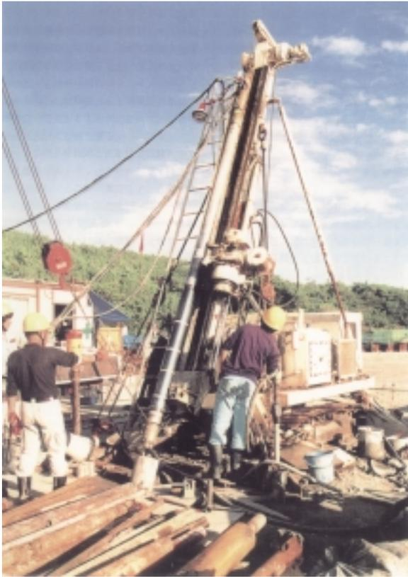
図2-2-8 当所で開発した岩盤用プレッシャーメータの全景<sup>(1)</sup>
