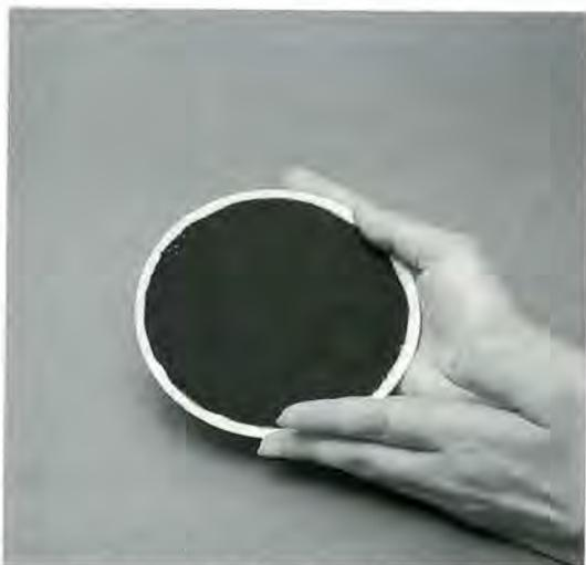
図5-1-1 試作したSOFC用単セル
