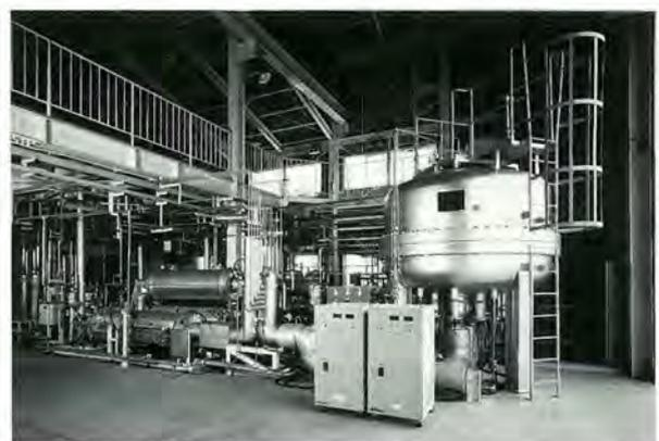
図4-1-17 10kW級MCFC実験設備
