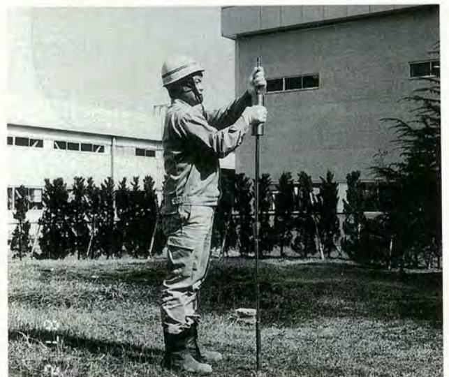
写真4-2-1 簡易な貫入試験装置
