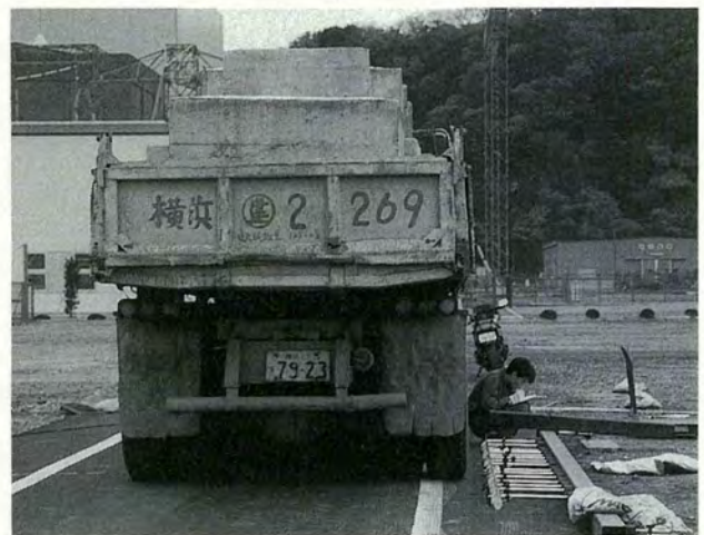
写真2-1-2 ダンプトラックによる載荷試験状況
