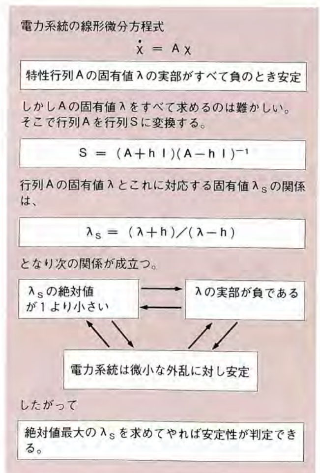
図2-2-6 S法の原理
