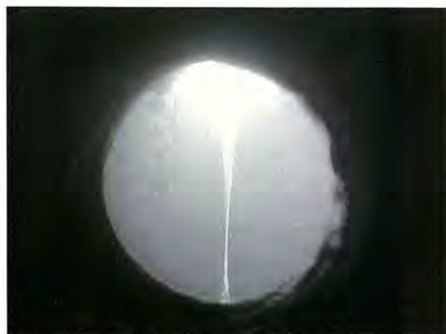
図2-1-3 スラグホール視窓より観察した熔融スラグ落下状況
