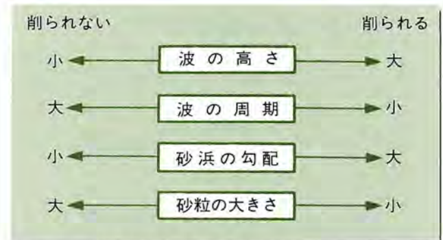
図2-2-2 砂浜が削られる条件
