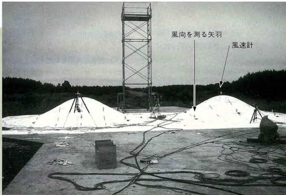
図3-1-6 開発した気流モデルの予測精度を検証するために実施した地形まわりの風向、風速を調べる野外実験状況
