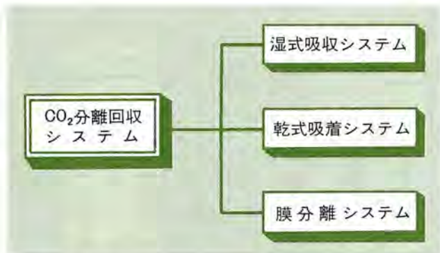
図1-1-15 CO 2 の分離・回収システムのうち、既存の火力発電プラントへの適用可能性が高いと考えられるものを現時点で選ぶと上図の3システムになる
