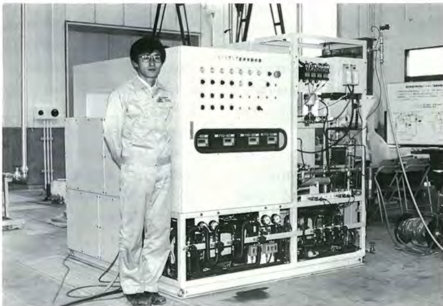
図3-2-3 試作した2段圧縮式ヒートポンプ(実用機では50×40×100cm位におさまる)
