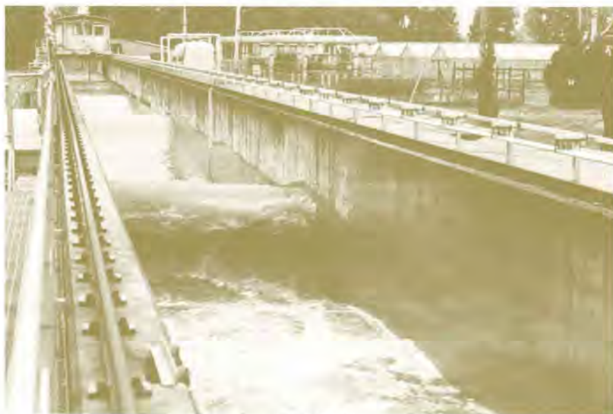
大型造波水路
