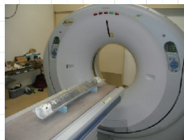
ボーリングコア試料の観察などに活用されているヘリカルX線CTスキャナ
