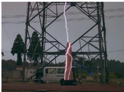
風車の羽根への雷撃実験
