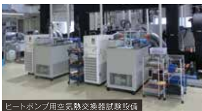
ヒートポンプ用空気熱交換器試験設備
