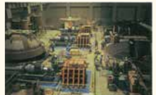
原子力発電所建屋内での起震実験
