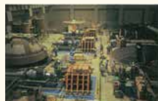
原子力発電所建屋内での起震実験
