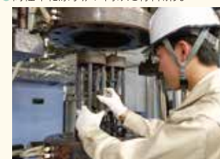
原子炉構造材料のき裂進展試験
