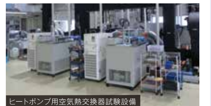
ヒートポンプ用空気熱交換器試験設備
