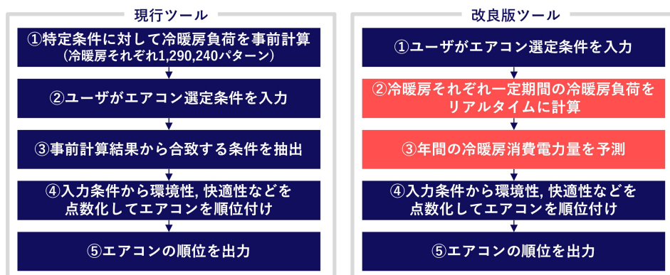
図2 現行ツールと改良版ツールそれぞれのプロセス(改良版での変更箇所を赤で記載)
