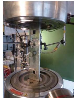
図-5 ボルト接合部の滑り実験の試験体の設置状況
