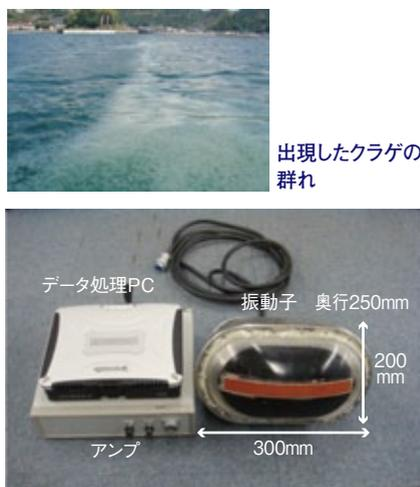
図-3 超音波クラゲ検知システム
