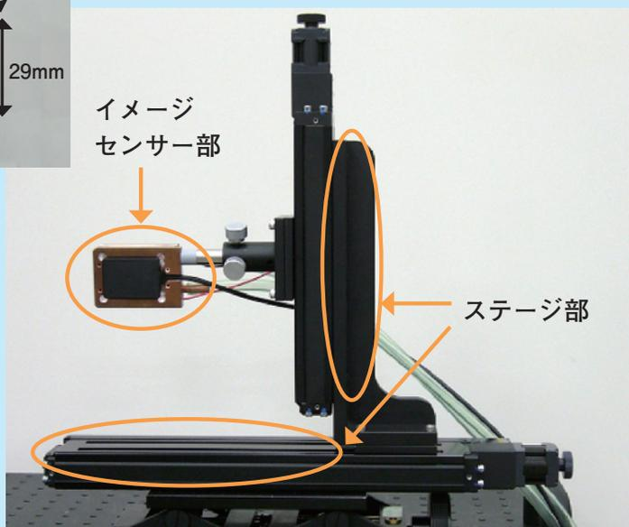
X線イメージングシステムの概観写真（右）とイメージセンサー部の拡大写真（左）
