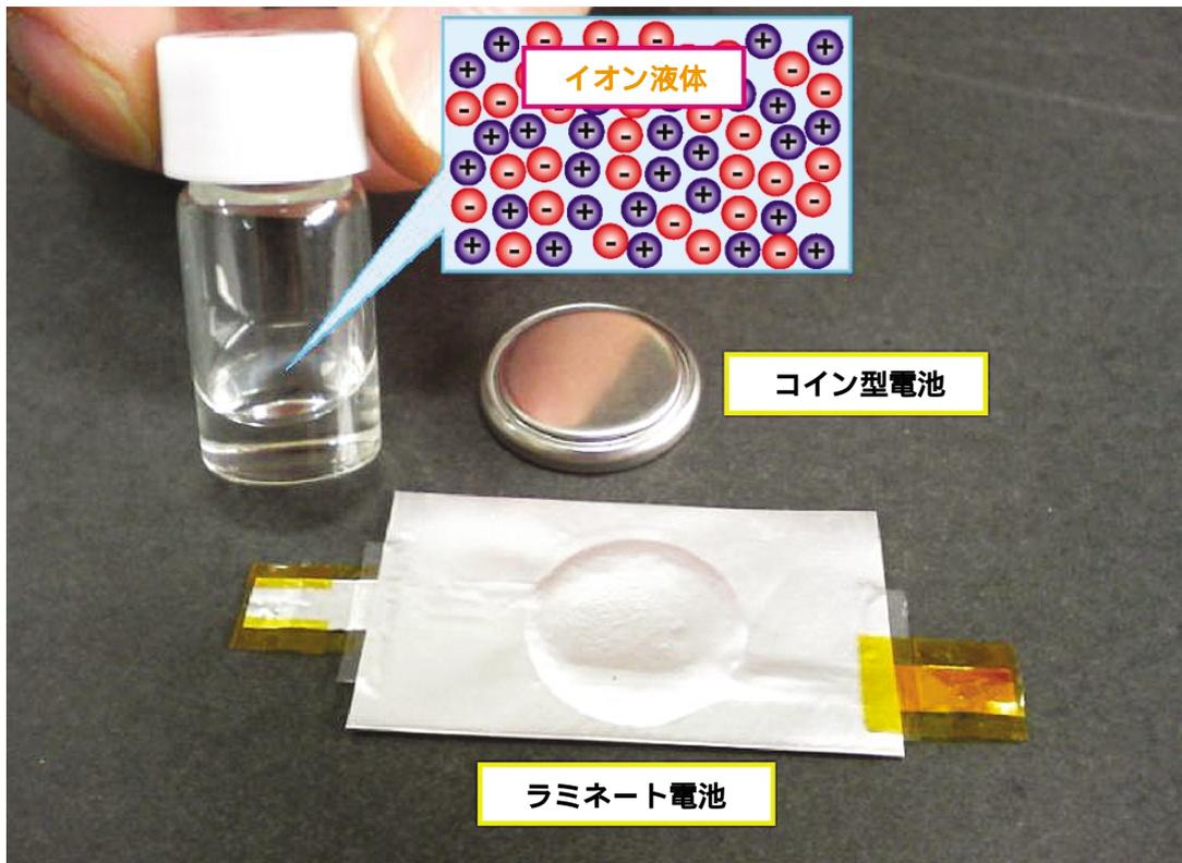
イオン液体を用いたコイン型及びラミネート型リチウム二次電池（試作品）
