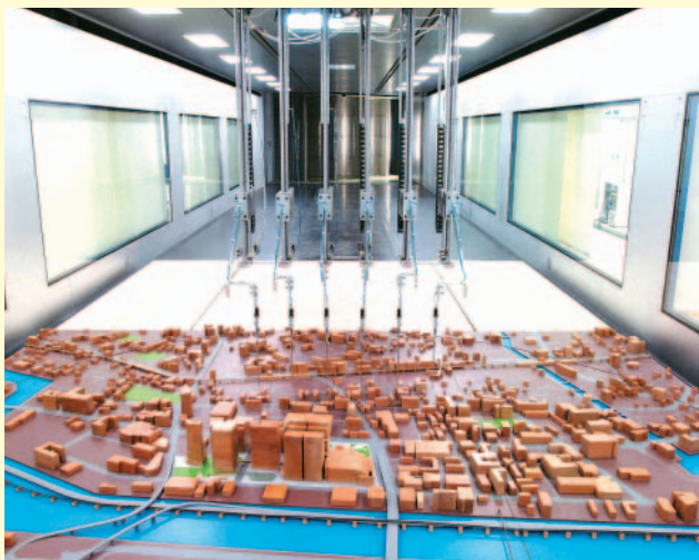
新風洞の第1試験セクション内を風下側から俯瞰。 6カ所の同時計測が可能
