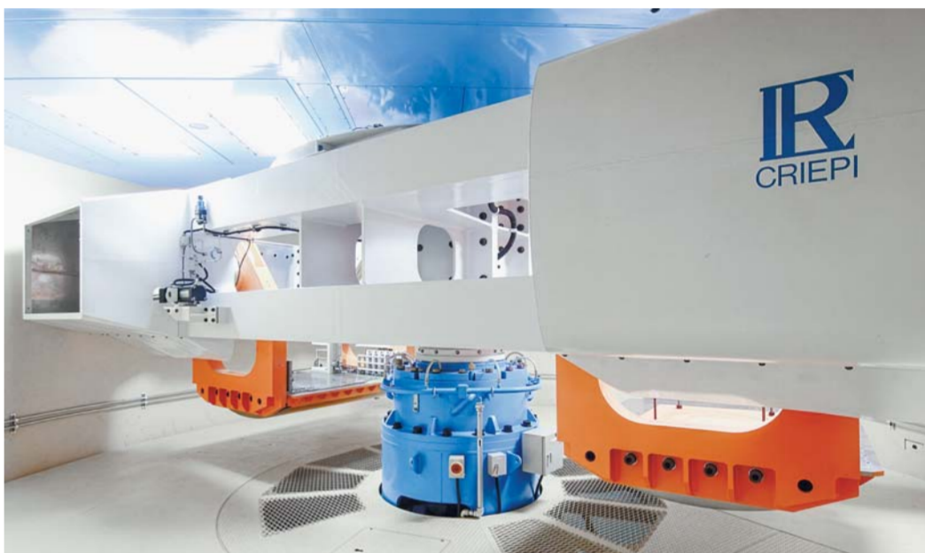
時間加速実験に用いる「遠心力载荷岩盤模型実験装置」。高レベル放射性廃棄物地層処分施設の数十年から数百年相当の挙動を数カ月で把握できる
