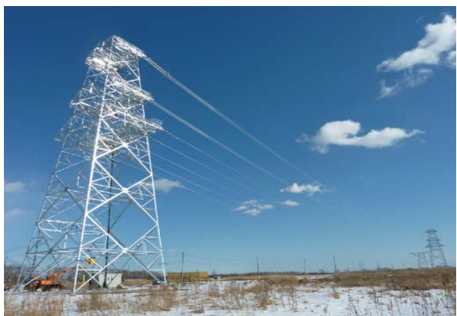
北海道釧路市に建設された「大規模送電線雪害試験設備」
