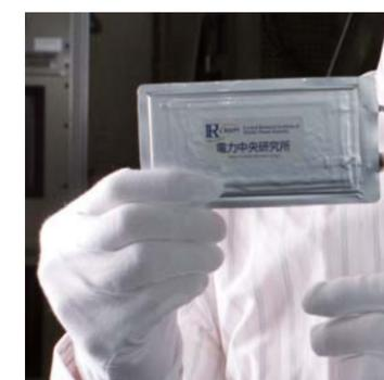
全固体型リチウム二次電池の試作品
