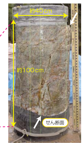
試験体には、試験によるせん断面（亀裂）が入っている。
