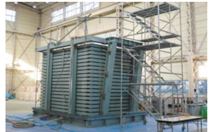
大型せん断土槽による液状化実験 基礎構造物の耐震性能試験として、地盤の液状化等による構造物への影響を評価するため、上記の大型振動台を使用したせん断土槽（幅2.5m×長さ3.5m×高さ3.0m）の振動実験を実施しています。
