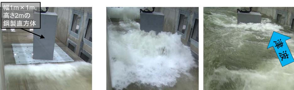
角柱模型に対して津波を作用させる実験の様子
