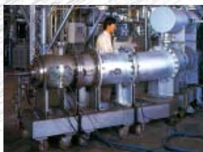
ガスタービン材料の高速燃焼ガスばく露試験 (H7年)
