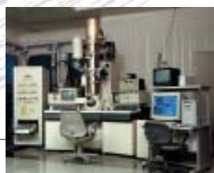
300kV電界放出型透過電子顕微鏡 (H7年)
