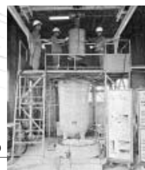
放射性廃棄物処分のための高水圧実験 (S49年～)
