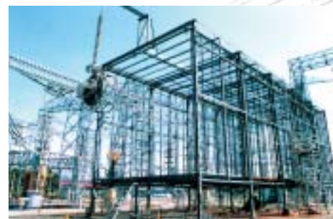
電線からのコロナ放電にともなう騒音などを解明するコロナケージ (S53年・塩原)
