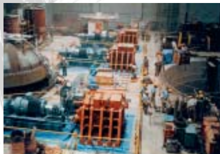
原子力発電所における建屋竣工前検査の起振実験(S52年～)
