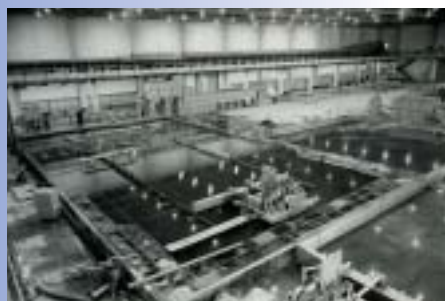
臨海および海中構造物の設計手法確立のための外洋波浪実験設備(S48年)
