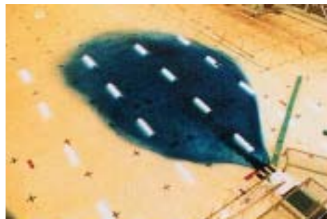
温排水の拡散予測実験 (S39年～)
