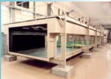
排ガスの拡散予測 (S39年～、写真はS48年に設置した長さ20mの温調拡散実験用風洞)
