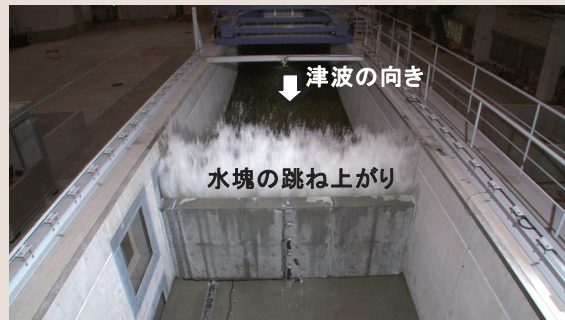
図2 津波・氾濫流水路での試験例
