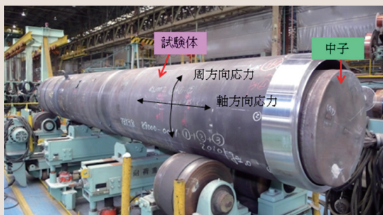
(1) 実機サイズの大口径配管(試験前)
