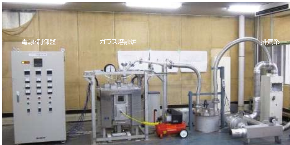
写真 小型ガラス溶融試験装置
