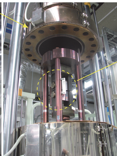
写真2 試験槽内部 中央の治具に試験片が装着されている。
