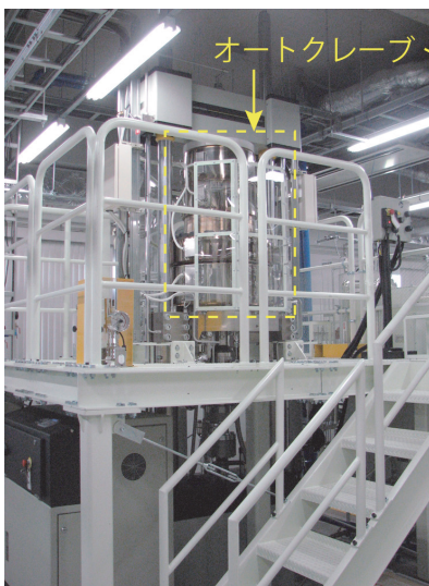
写真1 設備全体 中央が試験槽で、下側が油圧式荷重機構となっている。
