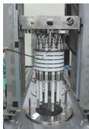
図3 電解還元装置(左)と得られた還元生成物(右) 電解還元装置では、最大で5.7kgのUO 2 を中心付近の4つのバスケットに装荷し、UO 2 のペレットを金属Uに還元する。
