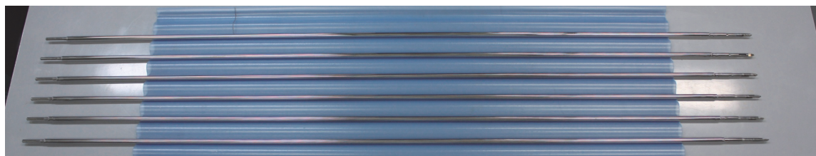
図1 製造した高速実験炉「常陽」照射用の金属燃料（直径8mm、全長60cm）
