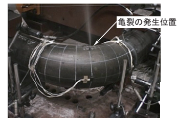
き裂貫通時の試験体 き裂貫通部から水の流出 が見られる。
