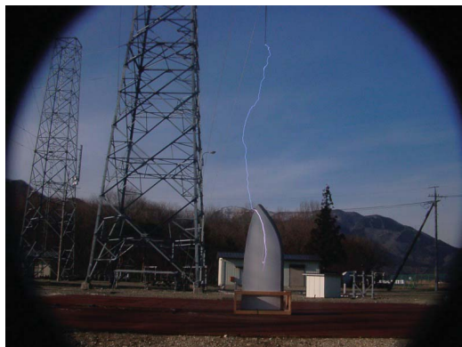
図1 風車の羽への落雷を模擬した実験
