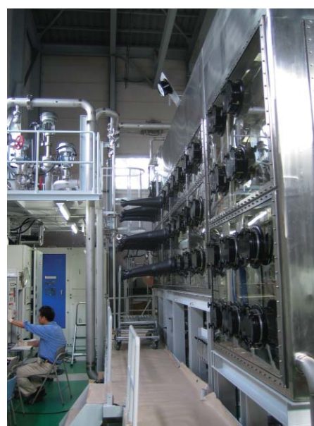
図4 大型アルゴン雰囲気グローブボックス設備
