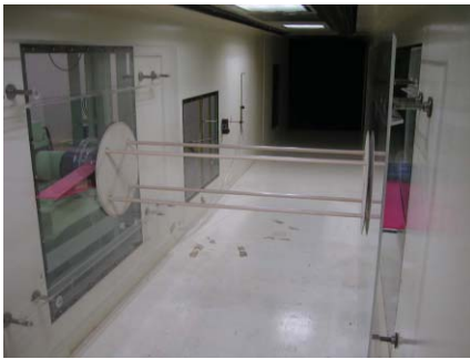
(a) 4導体部分模型の風洞内設置状況
