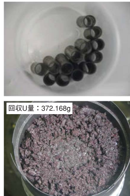
図-3 ステンレス被覆管付きの510gの金属ウランを全量溶解した後の陽極残留被覆管 (上) および析出物回収用バスケット (下)
