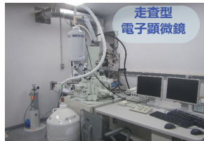
⑦電子顕微鏡により最新断層面沿いの鉱物の破壊・変形の有無を詳細に認定
