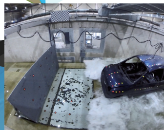
津波漂流物(車両)の衝突を再現した実物大模型実験
