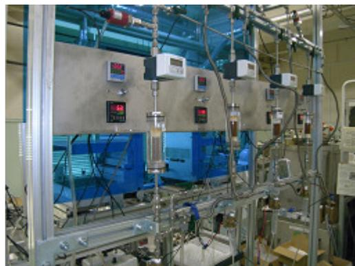
【汚染水浄化の模擬試験装置】
