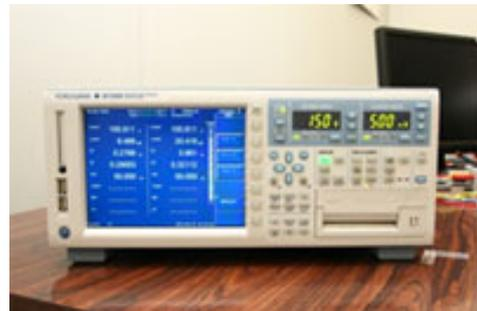
(写真 2) ハイエンド電力計 プレジジョンアナライザ WT3000
