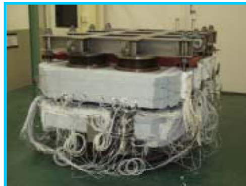
10kW 級 MCFC スタック概観
